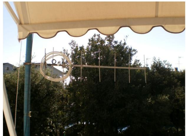
L'enorme vantaggio e offre un'antenna sorretta di coda come questa è innegabile: non si ha l'interferenza del mast in mezzo agli elementi parassiti che ne peggiorano guadagno e lobo d'irradiazione oltre che l'operazione di rotazione può avvenire in pochi secondi, se viene adottata una soluzione come la mia.
