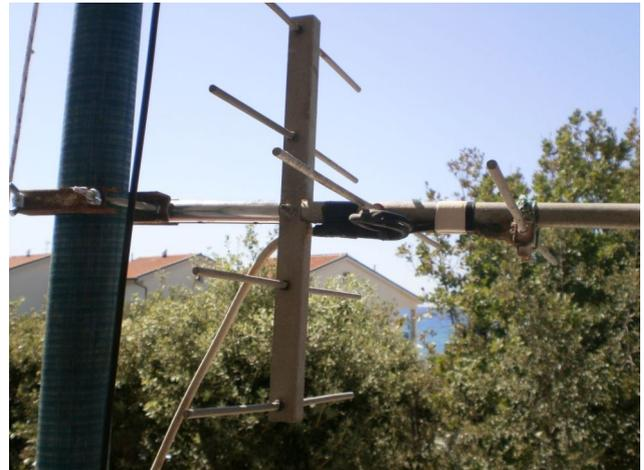
La rotazione da polarizzazione orizzontale a verticale avviene in pochi secondi, grazie alla possibilità di rotazione di un tubo attraverso l'altro.
